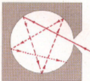
16.5 Die Strahlung, die durch ein kleines Loch aus einem erhitzten Hohlraum austritt, gleicht in guter Näherung der Strahlung eines schwarzen Körpers. Sie steht im Inneren mit den Wänden in thermischem Gleichgewicht, weil sie mehrfach absorbiert und wieder abgestrahlt wird, bevor sie austritt.
