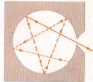
35.1 Experimentelle Realisierung eines schwarzen Körpers. Die durch die kleine Öffnung einfallende Strahlung wird an den Wänden reflektiert und nahezu vollständig absorbiert. Die Wahrscheinlichkeit für ein Entweichen durch die Öffnung ist sehr gering.
