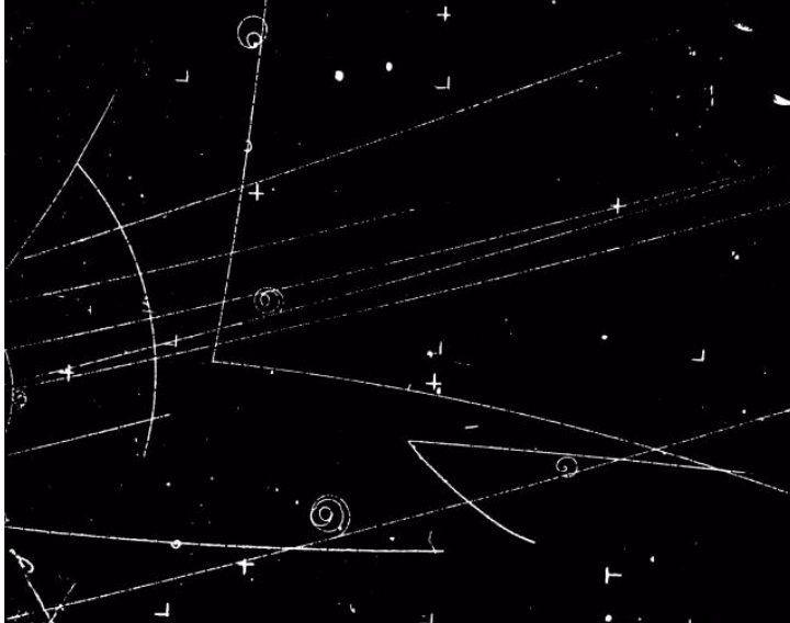
Bild 7 Blasenkammeraufnahme eines Pions, das von links eintritt und zwei ungeladene Teilchen erzeugt, die keine Spur hinterlassen und nach unterschiedlichen Wegstrecken in jeweils zwei geladene Teilchen zerfallen
