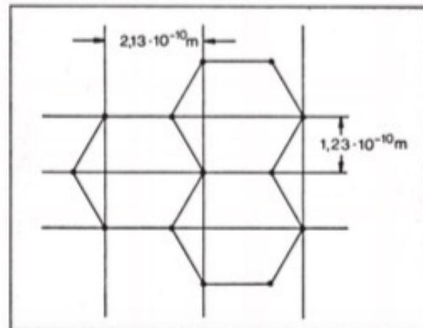
Nun wird das bei 5 kV erhaltene Beugungsbild untersucht; es sind zwei konzentrische Kreise mit den Radien  $R_1 = 1,1$  cm und  $R_2 = 1,9$  cm, sie entstehen durch Beugung der Elektronen an zwei Netzebenen des Graphits mit  $d_1 = 0,213$  nm und  $d_2 = 0,123$  nm (siehe Abb. 7). Setzt man die beiden erhaltenen Radien mit den Netzebenenabständen in (k) ein, so erhält man als experimentell ermittelte Wellenlängen:
