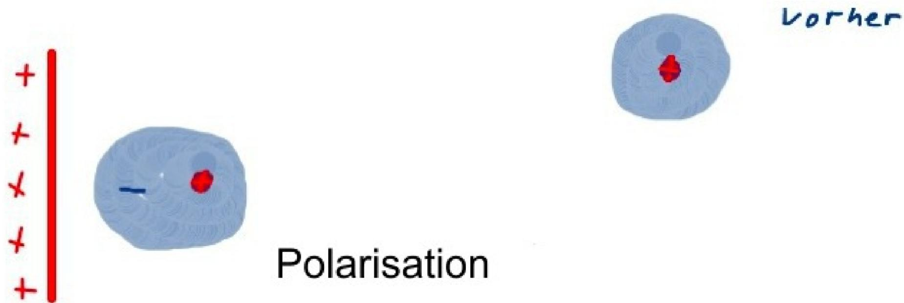
Durch Polarisation (oder bei Metallen Influenz) sind die entgegengesetzten Ladungen des neutralen Körpers näher an dem geladenen Stab als die gleichnamigen Ladungen. Die elektrische Kraft ist abstandsabhängig.
