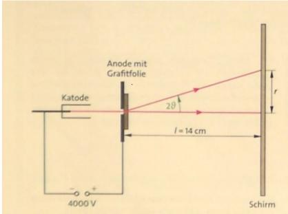
390.1 Schematische Darstellung des Aufbaus der Röhre zur Elektronenbeugung. Mit der Formel tan 2  $\theta = r/l$  und der Bragg'schen Gleichung 2  $d \sin \theta = \lambda$  lässt sich die Wellenlänge berechnen.
