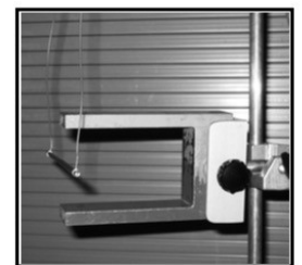
Abbildung 4a: Versuchsaufbau mit Hufeisenmagnet, der Kupferstab befindet sich in der Ruhelage
