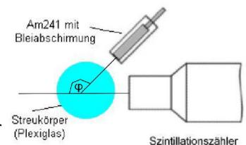
2.1. Ein  $\gamma$ -Strahlungsdetektor („Szintillationsdetektor mit Photomultiplier“) hat unter zwei Winkeln  $\varphi$  die  $\gamma$ -Spektren gemessen (s. unten rechts).
